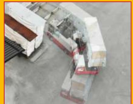
Mit einer Gesamtlänge von nur 3.980 mm und einer Fahrzeugbreite von 1.950 mm ist der Baumann ELX die wohl kompakteste und wendigste Maschine am Markt. Auch die Tischhöhe von lediglich 750 mm machen die ELX-Serie zum Star in jedem Lager.
