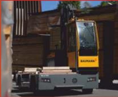
Mit über 8 Stunden ununterbrochener Betriebszeit pro Batterieladung, der vibrationsfrei gelagerten Panoramakabine, der leistungsstarken, präzise arbeitenden LoadSensing-Hydraulik, und der straßentauglichen LED-Beleuchtung ist der Baumann ELX einer der produktivsten und energieeffizientesten Seitenstapler, die je gebaut wurden.
