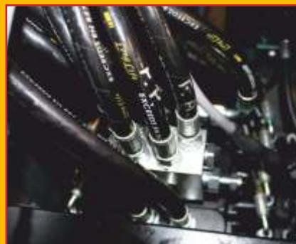
Die EGX-Serie nutzt eine leistungsstarke LoadSensing-Pumpe in Kombination mit einem Flowsharing-Ventil. Dieses hocheffiziente Hydrauliksystem stellt Hydraulikleistung nur dann zur Verfügung, wenn sie gebraucht wird. Das Ergebnis ist maximale Energieeffizienz. Ein kluges Design, das Ressourcen spart und die Umwelt schont.
