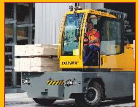
Der EGX verfügt über zwei Antriebsmotoren und eine 120 V Batterie mit großer Kapazität und langer Laufzeit. Die Ausstattung mit einer geräumigen Panoramakabine, LED-Beleuchtung, einer leistungsfähigen LoadSensing-Hydraulik und dem VRS-System machen den Baumann EGX zu einer echten Alternative zum verbrennungsmotorischen Seitenstapler.
