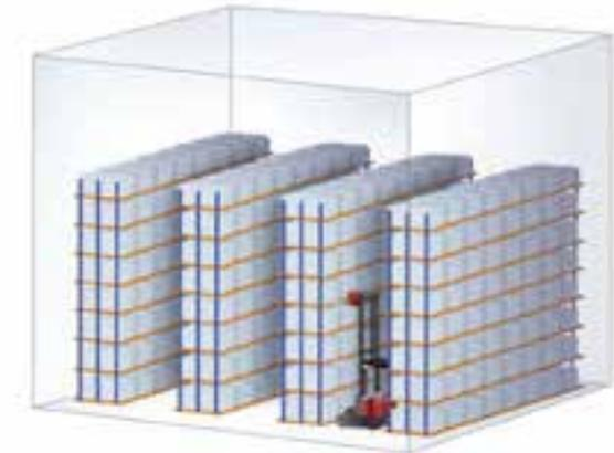
In einer typischen Lagerhalle liegt die benötigte Arbeitsgangbreite bei mindestens 2,7 m.
