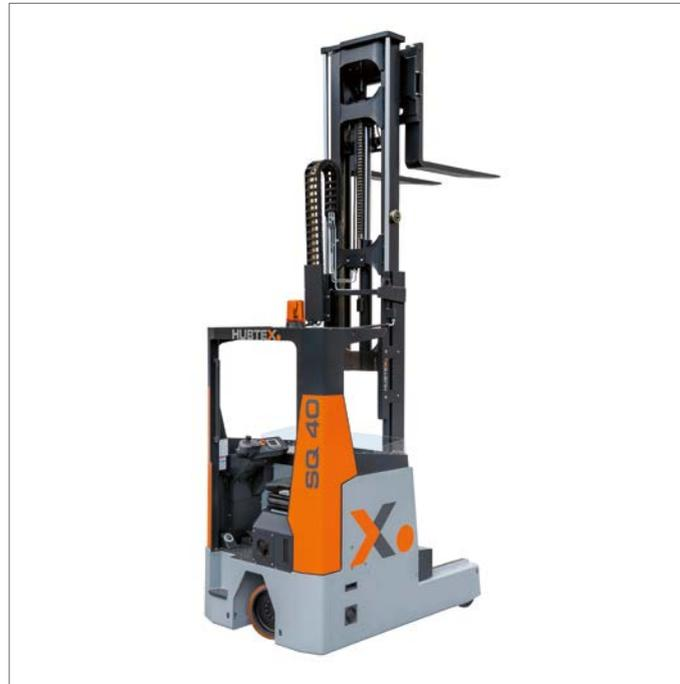
Der HUBTEX **Schubmaststapler** bietet eine deutlich höhere Tragfähigkeit bei gleicher Größe als herkömmliche Schubmaststapler. Dadurch kann der SQ bei gleichbleibenden Arbeitsgangbreiten eingesetzt werden. Energieeffiziente Steuerungen der neuesten Generation ermöglichen lange Batterieeinsatzzeiten und ein Höchstmaß an Umschlagsleistung.
