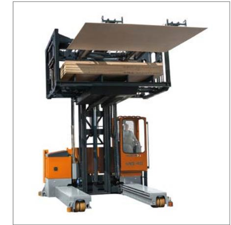
Sowohl Kommissionierplattformen als auch Mehrwegestapler können um **Vakuum-Saugvorrichtungen** zum Kommissionieren von Plattenmaterialien erweitert werden. Der VacumaX entlastet dabei die Beschäftigten beim Kommissionieren von schweren Plattenmaterialien und hilft Beschädigungen an der Ware zu reduzieren. Da das System vorzugsweise als aufnehmbare Variante ausgeführt wird, profitieren Anwender von der hohen Flexibilität der Fahrzeuge.
