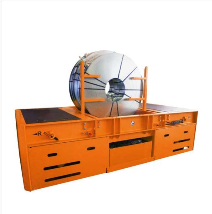
Die **Plattform- und Gleiswagen** sind selbstfahrende Fahrzeuge mit einer großen Ladefläche. Die Bedienung erfolgt wahlweise über eine Kabine, eine Fernsteuerung oder auch als fahrerloses Transportsystem. Sie werden für den innerbetrieblichen Transport von schweren Lasten aller Art verwendet, z. B. Bleche, Stahlträger, Coils, Maschinenteile, Gussstücke und Werkzeuge.
