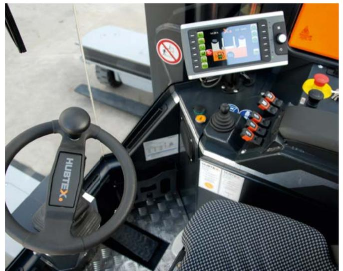
*Je nach Einsatzanforderung kann zwischen den drei Fahrmodi Eco, Sensitive und Speed gewechselt werden. Dadurch lassen sich Abgasemissionen und der Treibstoffverbrauch verringern.*
