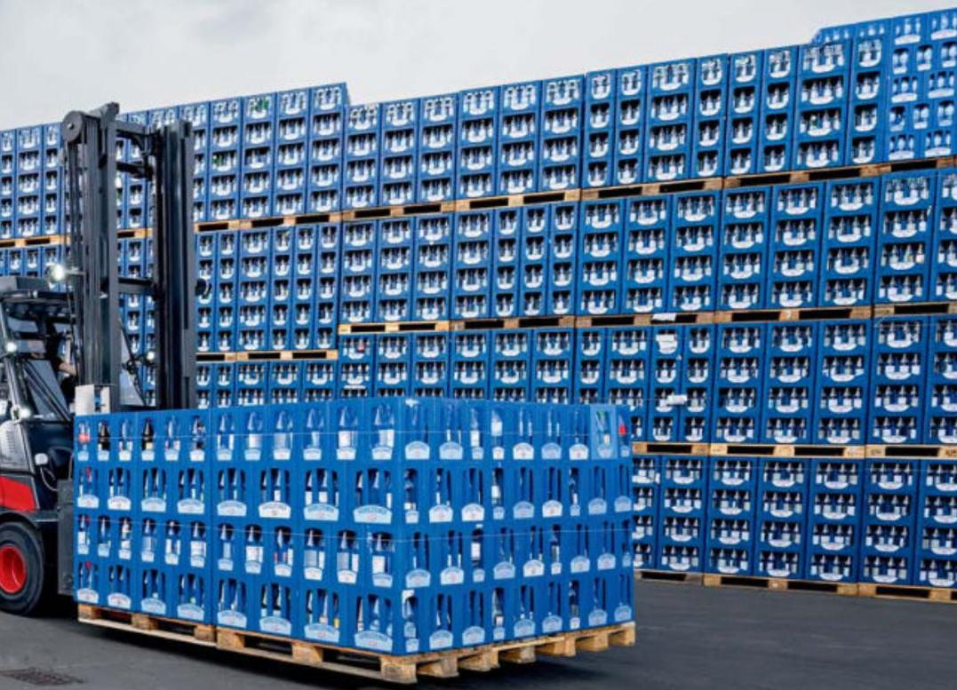
Frage „Blei-Säure oder Lithium-Ionen?“ betraf: „Wir hätten pro Stapler knapp drei Blei-Säure-Batterien zum Wechseln gebraucht und praktisch eine eigene Batterieladehalle vorhalten müssen, vom Wartungsaufwand ganz zu schweigen. Deshalb fiel die Entscheidung einstimmig für Li-ION.“
